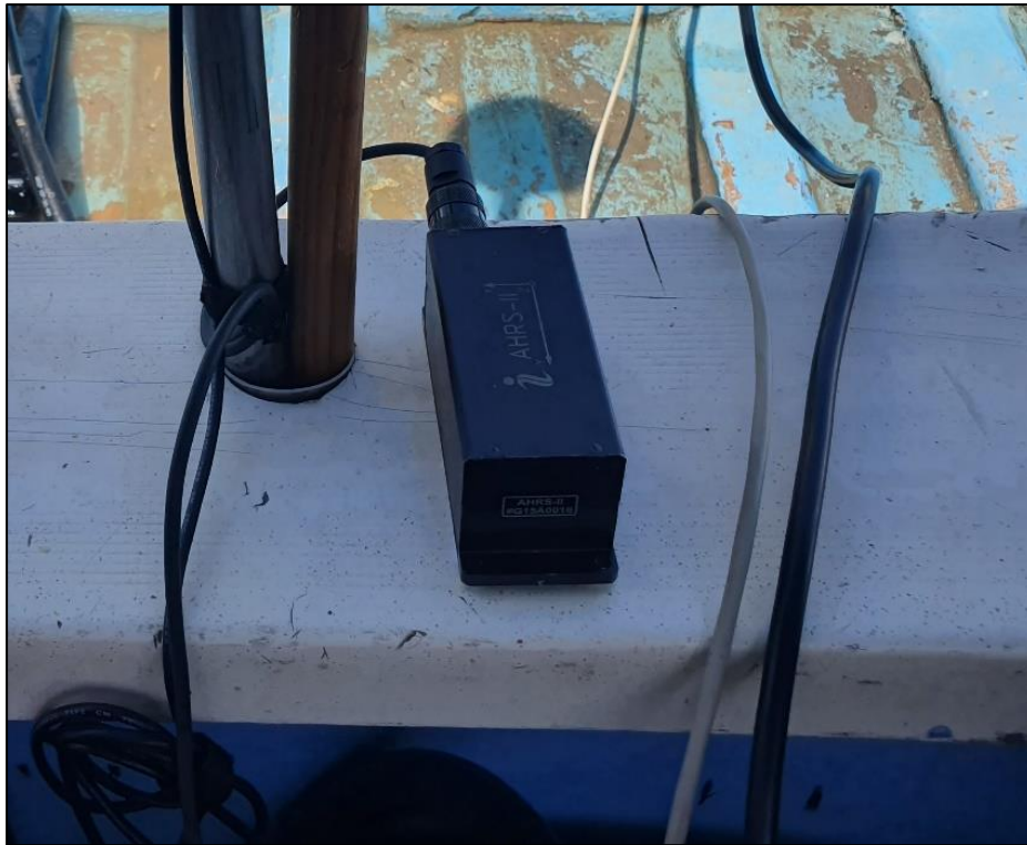
Figura 4.2.- Unidad de referencia de movimiento (MRU) montada en lancha
