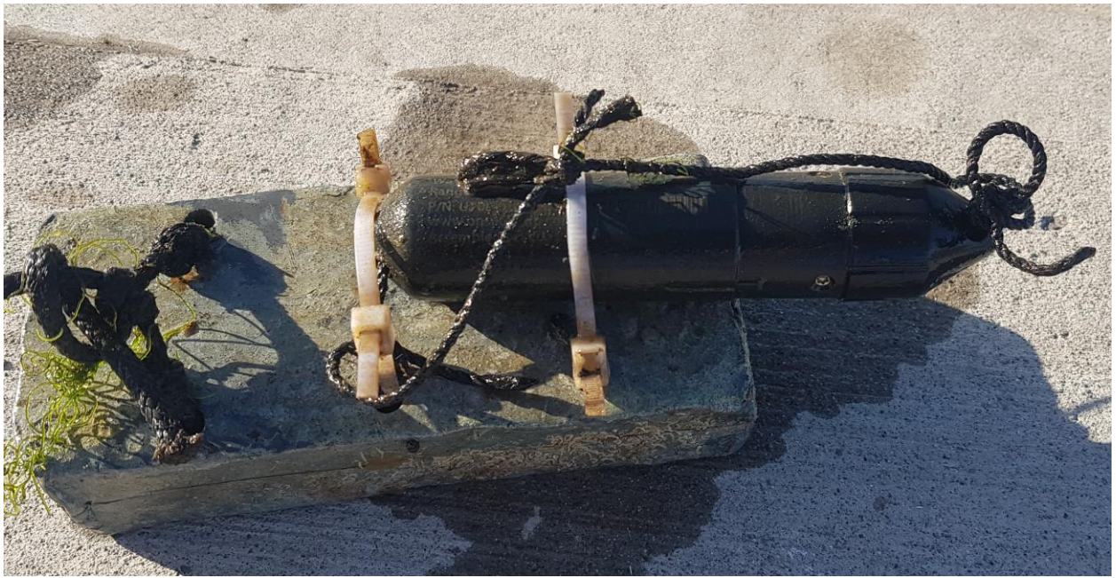
Figura 4.7.- Sensor de presión HOB0
